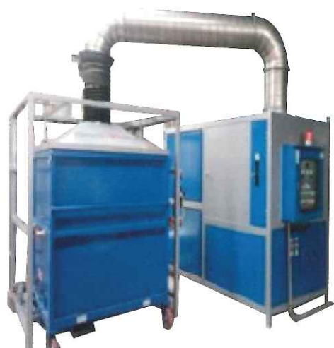
■ 低温式汚泥乾燥機 CDB-2000&3000(分離式)標準仕様
